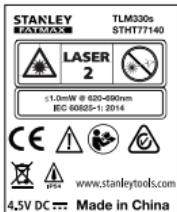
Seade TLM165S/TLM165SI/TLM330S kiirgab nähtavat laserikiirt, nagu näidatud joonisel A. Kiirguv laserikiir kuulub IEC 60825-1 standardi järgi 2. laseriklassi ning vastab 21 CFR 1040.10 ja 1040.11 nõuetele, välja arvatud erandid kooskõlas lasereid puudutava 24. juuni 2007. aasta teatisega nr 50.
