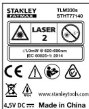
Verktøyet TLM165S/TLM165SI/TLM330S avgir en synlig laserstråle, som vist i figur A. Laserstrålen som avgis er i laserklasse 2 iht. IEC 60825-1, og samsvarer med 21 CFR 1040.10 og 1040.11, med unntak av avvik iht. Laser Notice No. 50 datert 24. juni 2007.
