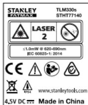
Verktyget TLM165S/TLM165SI/TLM330S utstrålar en synlig laserstråle, såsom visas i bild A. Laserstrålen som utstrålas är Laserklass 2 per IEC 60825-1 och uppfyller 21 CFR 1040.10 och 1040.11 förutom för avvikelse enligt Lasernotering nr. 50, daterad 24 juni, 2007.
